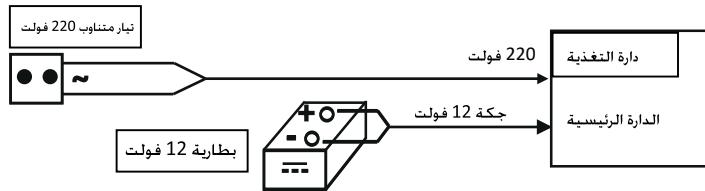
1). يحوي الجهاز على دارة حماية من التيارات العالية، فعندما يتم وصل الجهاز إلى مصدر تيار مستمر عالي (بين 15 فولت و 25 فولت)، كوصل الجهاز إلى بطارية 24 فولت فإن الجهاز سيحمي نفسه ولن يعمل.
